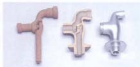
左が鋳物中子、中は鋳物製品の断面、右が鋳物製品。
